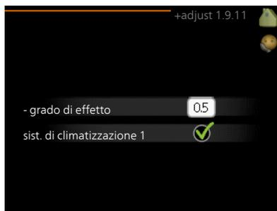
Utilizzando +Adjust, l'installazione comunica con il centro di controllo\* del riscaldamento a pavimento e regola la curva di riscaldamento e la temperatura di mandata calcolata in base all'impianto di riscaldamento a pavimento.
