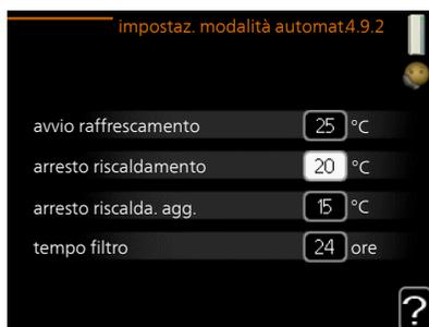
Quando la modalità operativa è impostata su "automatica", la pompa di calore seleziona quando è consentito avviare e arrestare il riscaldamento supplementare e produrre riscaldamento, in funzione della temperatura esterna media. Se sono presenti gli accessori per il raffrescamento, o se la pompa di calore dispone della funzione di raffrescamento integrata, è inoltre possibile selezionare la temperatura di avvio del raffrescamento.
