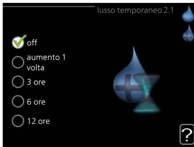
Quando il fabbisogno di acqua calda cresce temporaneamente, è possibile utilizzare questo menu per selezionare un aumento della temperatura dell'acqua calda in modalità lusso per un periodo di tempo selezionabile.
