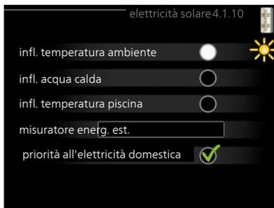
Qui è possibile impostare su quale parte dell'impianto (temperatura ambiente, temperatura acqua calda, temperatura piscina) deve sfruttare il surplus di elettricità solare.
