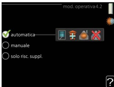
La modalità operativa della pompa di calore è in genere impostata su "automatica". È anche possibile impostare la pompa di calore su "solo risc. suppl.", ma solo in caso di utilizzo di un'aggiunta, o "manuale" e selezionare quali funzioni siano consentite.
