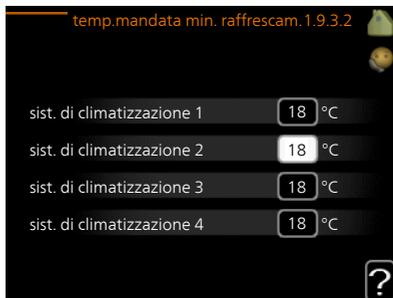
Nel menu 1.9.3 si seleziona il riscaldamento o il raffrescamento, nel menu successivo (riscaldamento/raffrescamento temp. mand. min.) si imposta la temperatura minima nella temperatura di mandata per il sistema di climatizzazione. Ciò significa che F1155 non calcola mai una temperatura inferiore a quella impostata qui.
