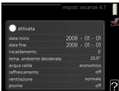
Se è installato e attivo un sensore ambiente, la temperatura ambiente desiderata (°C) viene impostata durante il periodo di tempo. Tale impostazione si applica a tutti i sistemi di climatizzazione con sensori ambiente.
