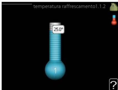
Il valore nel display appare come una temperatura espressa in °C se l'impianto di climatizzazione è controllato mediante un sensore ambiente.
