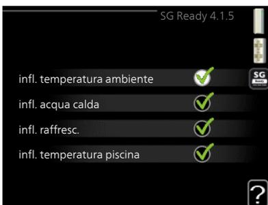
Con la modalità a basso costo su "SG Ready" il valore di offset della temperatura interna viene aumentato di "+1". Se viene installato un sensore ambiente ed è attivo, la temperatura ambiente desiderata viene aumentata di 1 °C.
