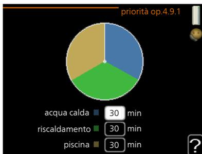
Scegliere la durata di funzionamento della pompa di calore per ogni richiesta in presenza di due o più richieste in contemporanea. Se vi è una sola richiesta, la pompa di calore funziona solo per quella.
