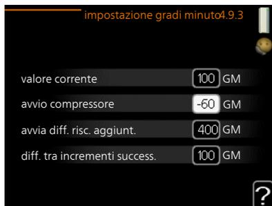
I gradi minuto misurano la richiesta di riscaldamento corrente nell'abitazione e determinano quando il compressore/riscaldamento supplementare entrerà in funzione/si arresterà.
