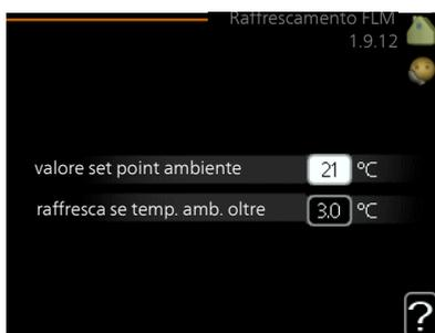
Una volta attivato Raffrescamento FLM nel menu 5.3.1, impostare la temperatura ambiente desiderata in questo menu. Si seleziona anche la temperatura a cui deve avviarsi il raffrescamento.
