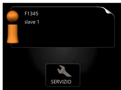
Se la pompa di calore è impostata come slave, viene visualizzato un menu principale limitato, in quanto la maggior parte delle impostazioni del sistema viene effettuata a livello della pompa di calore master.
