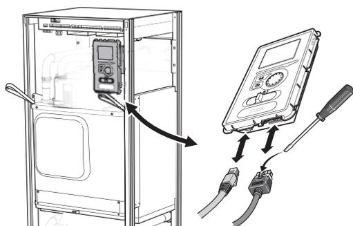
7. Rimuovere le due viti che trattengono il display nel telaio (questa procedura è necessaria soltanto se si intende estrarre il modulo frigorifero superiore).
