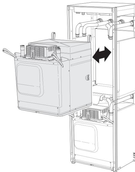
9. Estrarre con cura il modulo frigorifero inferiore (EP14) mediante gli appositi anelli di sollevamento.
