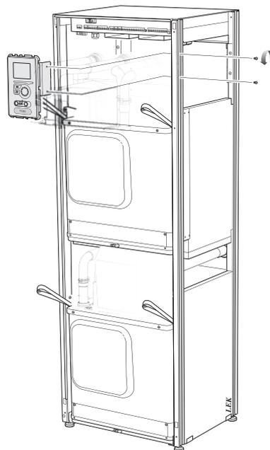
8. Estrarre con cura il modulo frigorifero superiore (EP15) mediante gli appositi anelli di sollevamento. Per questa procedura, utilizzare una superficie di appoggio ausiliaria regolabile in altezza.
