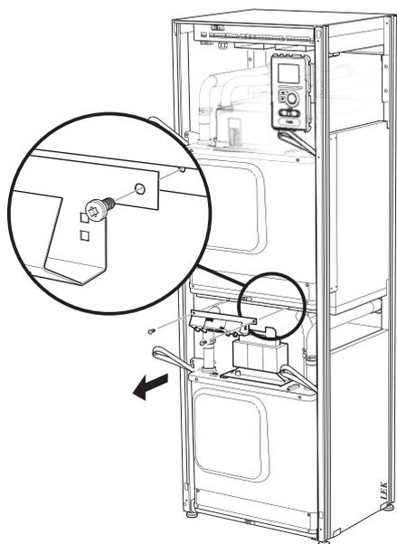
10. Estrarre con cura il modulo frigorifero inferiore (EP14) mediante gli appositi anelli di sollevamento.
