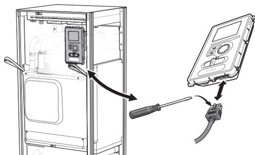
7. Rimuovere le due viti che trattengono il display nel telaio (questa procedura è necessaria soltanto se si intende estrarre il modulo frigorifero superiore).
