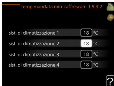
Nel menu 1.9.3 si seleziona il riscaldamento o il raffrescamento, nel menu successivo (riscaldamento/raffrescamento temp. mand. min.) si imposta la temperatura minima nella temperatura di mandata per il sistema di climatizzazione. Ciò significa che VVM 320 non calcola mai una temperatura inferiore a quella impostata qui.
