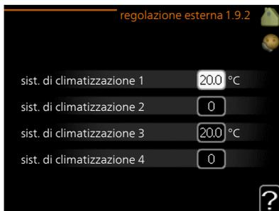
Collegando un contatto esterno, ad esempio un termostato ambiente o un timer, è possibile aumentare o abbassare temporaneamente o periodicamente la temperatura ambiente durante il riscaldamento. Quando il contatto viene attivato, il valore di offset della curva di riscaldamento viene modificato del numero di livelli selezionato nel menu. Se viene installato un sensore ambiente ed è attivo, la temperatura ambiente desiderata (°C) viene impostata.
