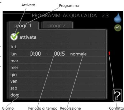
*Regolazione:* Impostare qui il livello di comfort dell'acqua calda da applicare durante la programmazione.
