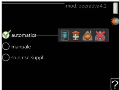
La modalità operativa del modulo interno è in genere impostata su "automatica". È anche possibile impostare il modulo interno su "solo risc. suppl.", ma solo in caso di utilizzo di un'aggiunta, o "manuale" e selezionare quali funzioni siano consentite.
