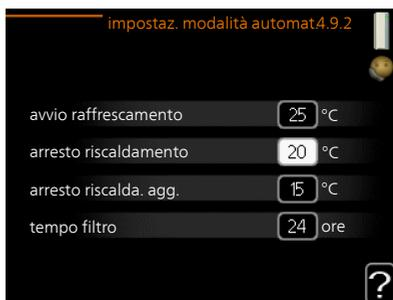
Quando la modalità operativa è impostata su "automatica", il modulo di controllo seleziona quando è consentito avviare e arrestare il riscaldamento aggiuntivo e produrre riscaldamento, in funzione della temperatura esterna media. Se la pompa di calore è dotata di una funzione di raffrescamento integrata ed è attivata nel menu, è inoltre possibile selezionare la temperatura di avvio del raffrescamento.
