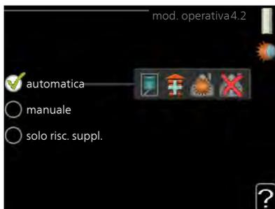
La modalità operativa del modulo di controllo è in genere impostata su "automatica". È anche possibile impostare il modulo di controllo su "solo risc. suppl.", quando viene utilizzato "solo risc. suppl." o "manuale" e poi selezionare quali funzioni devono essere consentite.
