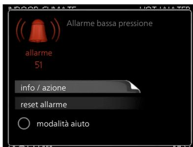
Se rimane visibile una spia rossa e sullo schermo appare il menu "alarm", il problema che ha causato l'allarme non è ancora stato risolto. Se l'allarme scompare inizialmente ma si ripresenta, contattare l'installatore.
