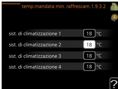
Nel menu 1.9.3 si seleziona il riscaldamento o il raffrescamento, nel menu successivo (riscaldamento/raffrescamento temp. mand. min.) si imposta la temperatura minima nella temperatura di mandata per il sistema di climatizzazione. Ciò significa che SMO 40 non calcola mai una temperatura inferiore a quella impostata qui.
