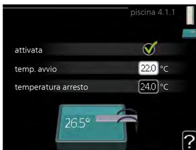
Selezionare se occorre attivare il controllo della piscina, entro quali temperature (di avvio e arresto) deve avvenire il riscaldamento della piscina e quanti compressori possono essere in funzione contemporaneamente per la piscina.
