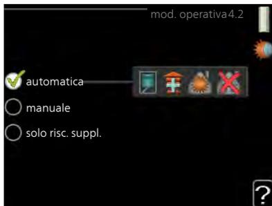
La modalità operativa del modulo di controllo è in genere impostata su "automatica". È anche possibile impostare il modulo di controllo su "solo risc. suppl.", quando viene utilizzato "solo risc. suppl." o "manuale" e poi selezionare quali funzioni devono essere consentite.
