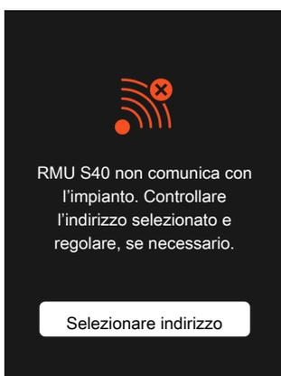
6. È possibile scegliere di controllare il prodotto principale secondo il contenuto di umidità (UR) nell'aria, misurato da RMU S40. Attivare questa scelta nel menu 7.1.6.4 - "Controllo umidità" nel prodotto principale.
