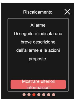
In caso di allarme, si è verificato un qualche malfunzionamento, indicato dalla spia di stato illuminata con una luce rossa fissa. Viene visualizzata sul display una finestra di dialogo contenente informazioni sull'allarme.
