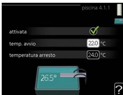
Selezionare se attivare il controllo piscina ed entro quali temperature (di avvio e di arresto) la piscina viene riscaldata.
