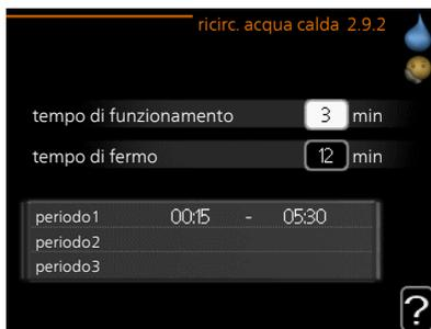
Impostare qui il ricircolo dell'acqua calda per un massimo di tre periodi al giorno. Durante i periodi impostati, la pompa di ricircolo dell'acqua calda resterà in funzione in base alle impostazioni di cui sopra.
