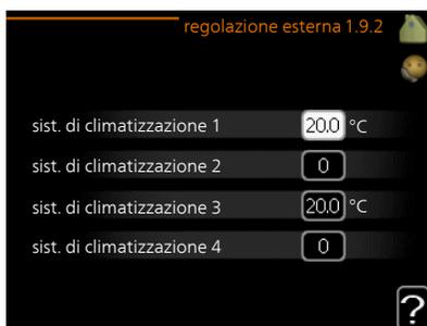
Collegando un contatto esterno, ad esempio un termostato ambiente o un timer, è possibile aumentare o abbassare temporaneamente o periodicamente la temperatura ambiente durante il riscaldamento. Quando il contatto viene attivato, il valore di offset della curva di riscaldamento viene modificato del numero di livelli selezionato nel menu. Se viene installato un sensore ambiente ed è attivo, la temperatura ambiente desiderata (°C) viene impostata.
