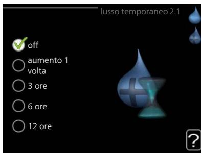
Quando il fabbisogno di acqua calda cresce temporaneamente, è possibile utilizzare questo menu per selezionare un aumento della temperatura dell'acqua calda in modalità lusso per un periodo di tempo selezionabile.
