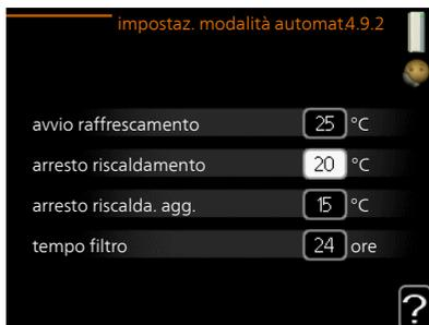
Quando la modalità operativa è impostata su "automatica", il modulo interno seleziona quando è consentito avviare e arrestare il riscaldamento aggiuntivo e produrre riscaldamento, in funzione della temperatura esterna media. Se sono presenti gli accessori per il raffrescamento, o se la pompa di calore dispone della funzione di raffrescamento integrata ed è attivata nel menu, è inoltre possibile selezionare la temperatura di avvio del raffrescamento.
