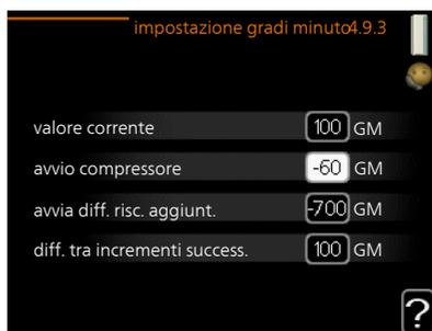
I gradi minuto misurano la richiesta di riscaldamento corrente nell'abitazione e determinano quando il compressore/riscaldamento supplementare entrerà in funzione/si arresterà.
