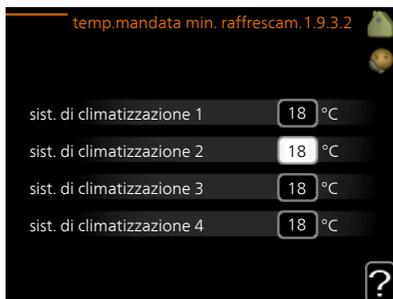
Nel menu 1.9.3 si seleziona il riscaldamento o il raffrescamento, nel menu successivo (riscaldamento/raffrescamento temp. mand. min.) si imposta la temperatura minima nella temperatura di mandata per il sistema di climatizzazione. Ciò significa che VVM 310 non calcola mai una temperatura inferiore a quella impostata qui.
