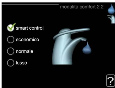
La differenza tra le modalità selezionabili è la temperatura dell'acqua calda del rubinetto. Una temperatura elevata indica che l'acqua calda dura di più.
