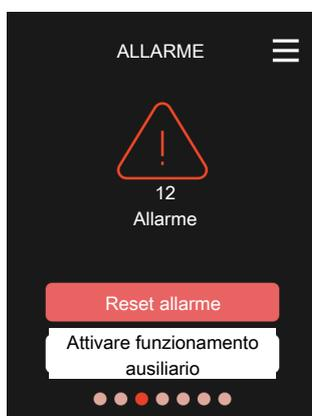
Qui è possibile ripristinare l'allarme pertinente. È inoltre possibile attivare/disattivare il funzionamento ausiliario.
