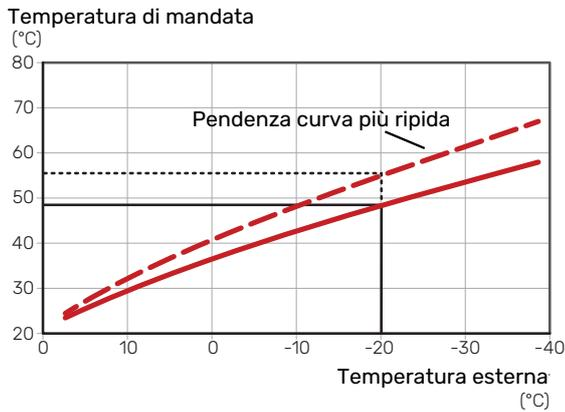
La pendenza ottimale della curva dipende dalle condizioni climatiche del posto, dalla presenza o meno di radiatori, ventilconvettori o di riscaldamento a pavimento nell'abitazione e dal grado di isolamento dell'abitazione.
