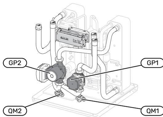
L'immagine mostra un esempio del possibile aspetto di una sezione di raffreddamento.
