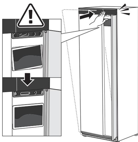
4. Premere la parte superiore della sezione anteriore contro il telaio e avvitare in posizione.
