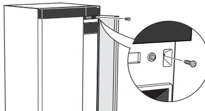
2. Tirare il bordo superiore del pannello verso di sé e sollevarlo in alto, diagonalmente, per rimuoverlo dal telaio.
