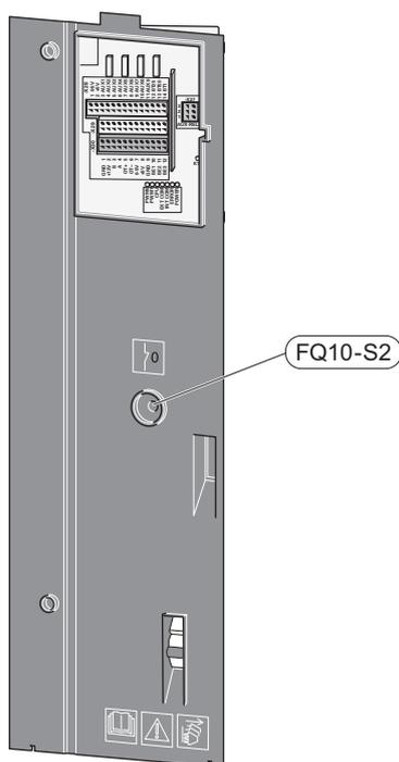
Il limitatore di temperatura (FQ10) interrompe l'alimentazione al riscaldamento supplementare elettrico se la temperatura supera 89 °C e può essere ripristinato manualmente.
