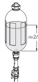
Se la pressione nell'impianto deve essere aumentata, ciò viene fatto chiudendo la valvola sulla tubatura principale in uscita quando la pompa del glicole (GP2) è in funzione e il vaso di livello (CM2) è aperto, in modo che il liquido scorra dal vaso.
