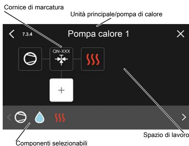
*Unità principale/pompa di calore:* Qui è possibile selezionare la pompa di calore per cui deve essere effettuata l'impostazione di collegamento (se la pompa di calore è solitaria nel sistema, viene visualizzata solo l'unità principale).
