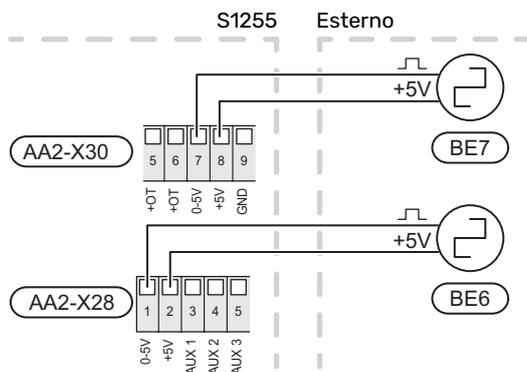
Attivare il/i misuratore/i nel menu 7.2 - "Impostazioni accessori" poi impostare il valore desiderato ("Energia per impulso" o "Impulsi per kWh") nel menu 7.2.19 - "Misur. energetico a impulsi".
