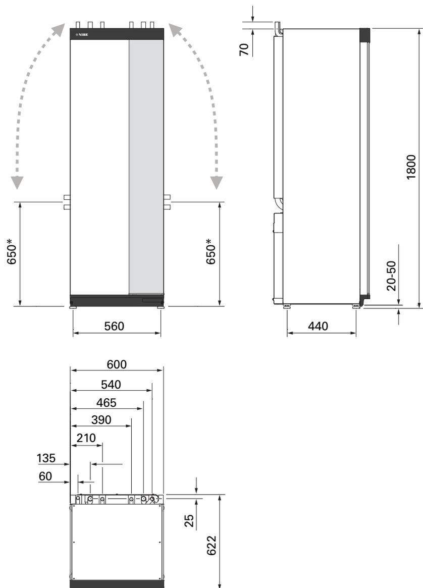
\* Questa dimensione riguarda i tubi del glicole a 90° (attacco laterale). La dimensione può variare di circa  $\pm 100$  mm in verticale, poiché i tubi del glicole sono costituiti in parte da tubi flessibili.
