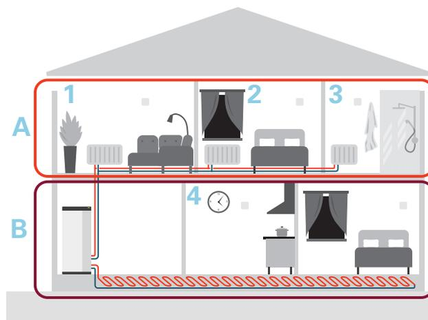
L'esempio mostra una proprietà con due impianti di climatizzazione (A e B) divisi in quattro zone (1-4). Temperatura e ventilazione on demand possono essere controllate individualmente per ogni zona (accessorio richiesto).
