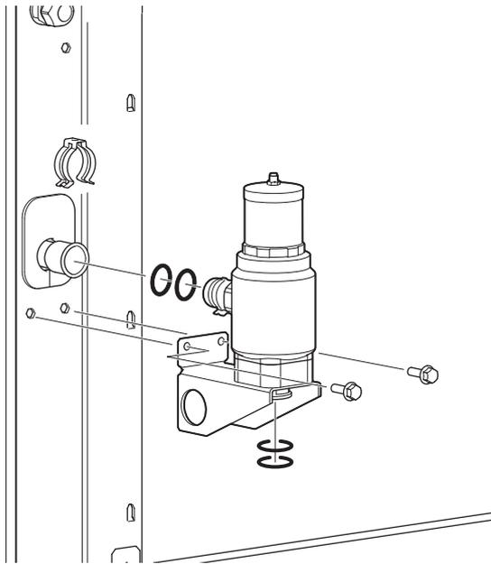
2. Montare le parti della valvola di sicurezza. Assicurarsi che la freccia per l'uscita sia rivolta verso il basso, come illustrato.
