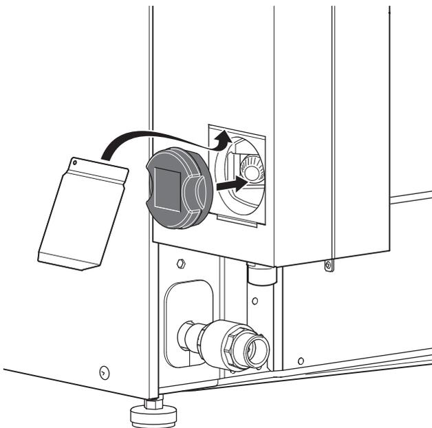
11. Avvitare in posizione i tubi flessibili. I tubi flessibili possono essere installati angolati, dritti, dietro o sotto, a seconda del collegamento idraulico su cui la curva a 90°
