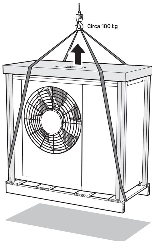
Se l'unità S2125 deve essere trasportata su terreno molle, come ad esempio un prato, raccomandiamo l'utilizzo di un'autogru che sia in grado di sollevare l'unità e trasportarla nel punto d'installazione. In caso di sollevamento di S2125 mediante una gru, l'imballaggio dovrà risultare integro.
