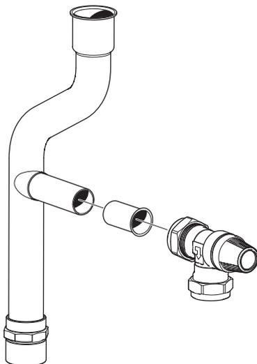
3. Quindi montare la valvola di sicurezza con i tubi associati. La valvola di sicurezza deve trovarsi a un angolo di 45°. Montare la clip. Girare la clip per garantire che si fissi correttamente.
