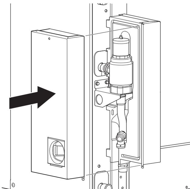
8. Montare il coperchio. Fissare con tre viti. Due viti sul coperchio, sui lati destro e sinistro, e una vite sul fondo.
