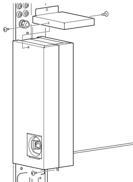
9. Fissare il separatore del gas alla pompa di calore con due viti, una sopra e una sul fondo.
