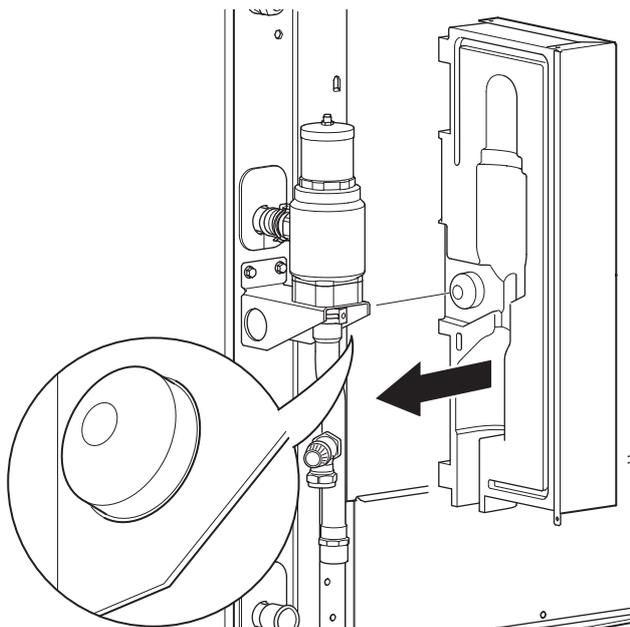
7. Verificare che entrambe le metà del separatore del gas siano correttamente posizionate, parallelamente al bordo della pompa di calore.
