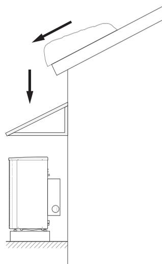
Qualora esista il rischio di caduta di neve dal tetto, installare una tettoia protettiva per proteggere la pompa di calore, i tubi e il cablaggio.
