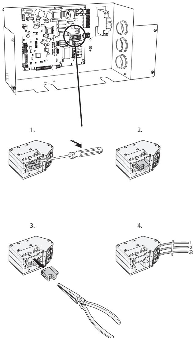
Collegare la tensione di controllo esterna (230V~ 50Hz) alla morsetteria X5:L, X5:N e X5:PE (come illustrato).
