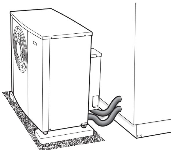
Tutti i tubi esterni devono essere isolati con materiale isolante per tubi avente uno spessore di almeno 19 mm.
