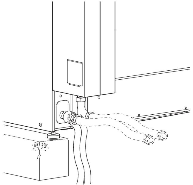
12. Verificare che l'apertura di sfogo non sia coperta con l'isolamento del tubo. L'isolamento del tubo deve estendersi fino al giunto e non deve coprire l'apertura.
