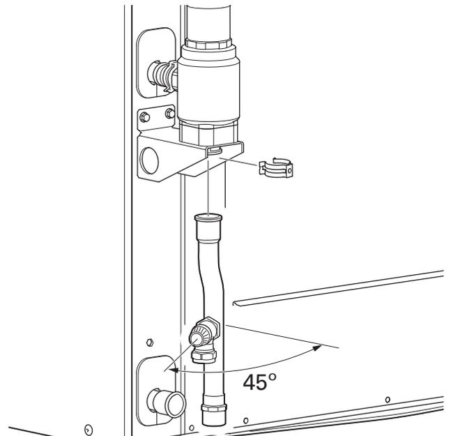
4. Installare la valvola di non ritorno. Montare la clip. Girare la clip per garantire che si fissi correttamente.
