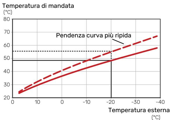
La pendenza ottimale della curva dipende dalle condizioni climatiche del posto, dalla presenza o meno di radiatori, ventilconvettori o di riscaldamento a pavimento nell'abitazione e dal grado di isolamento dell'abitazione.
