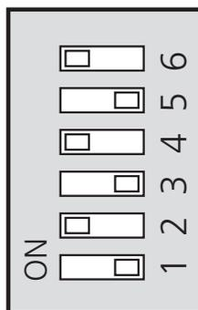
L'immagine mostra il dipswitch (AA1-SF1) nella configurazione di fabbrica, ovvero 8 kW.
