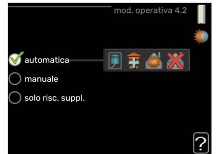
La modalità operativa del modulo interno è in genere impostata su "automatica". È anche possibile impostare il modulo interno su "solo risc. suppl.", ma solo in caso di utilizzo di un'aggiunta, o "manuale" e selezionare quali funzioni siano consentite.
