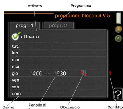
Quando la programmazione è attiva, nel menu principale verrà visualizzato il relativo simbolo del bloccaggio sul simbolo del modulo interno.
