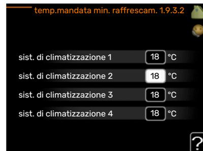
Nel menu 1.9.3 si seleziona il riscaldamento o il raffrescamento, nel menu successivo (riscaldamento/raffrescamento temp. mand. min.) si imposta la temperatura minima nella temperatura di mandata per il sistema di climatizzazione. Ciò significa che VVM 310 non calcola mai una temperatura inferiore a quella impostata qui.
