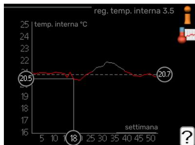
La temperatura media interna viene visualizzata soltanto se è installato un sensore della temperatura ambiente / un'unità ambiente.
