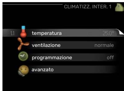
**temperatura** Impostazione della temperatura per il sistema di climatizzazione. Le informazioni di stato mostrano i valori impostati per il sistema di climatizzazione.
