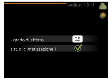
Utilizzando +Adjust, l'installazione comunica con il centro di controllo\* del riscaldamento a pavimento e regola la curva di riscaldamento e la temperatura di mandata calcolata in base all'impianto di riscaldamento a pavimento.
