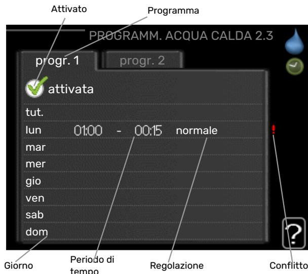
Qui è possibile programmare per un massimo di due diversi periodi al giorno il livello di comfort dell'acqua calda che il modulo interno deve utilizzare.
