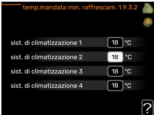
Nel menu 1.9.3 si seleziona il riscaldamento o il raffrescamento, nel menu successivo (riscaldamento/raffrescamento temp. mand. min.) si imposta la temperatura minima nella temperatura di mandata per il sistema di climatizzazione. Ciò significa che VVM 500 non calcola mai una temperatura inferiore a quella impostata qui.
