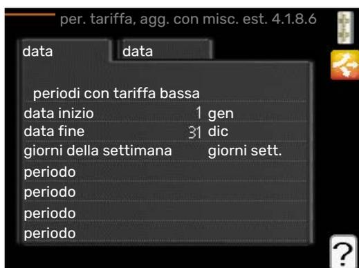
Qui è possibile utilizzare il controllo delle tariffe per il riscaldamento supplementare con miscelatrice.
