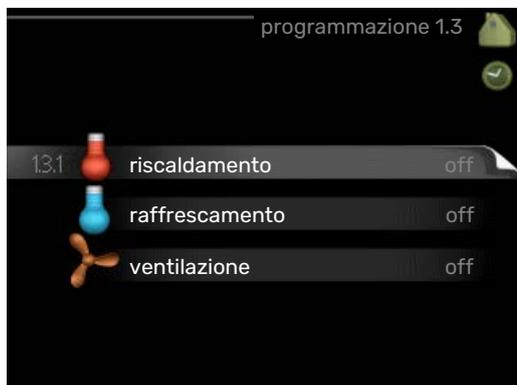
Nel menu **programmazione** la climatizzazione interna (riscaldamento/raffrescamento/ventilazione) è programmata per ciascun giorno ferialo.
