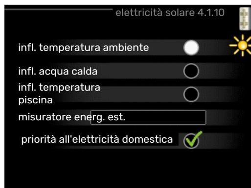
Qui è possibile impostare su quale parte dell'impianto (temperatura ambiente, temperatura acqua calda, temperatura piscina) deve sfruttare il surplus di elettricità solare.
