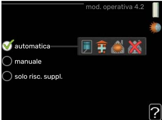
La modalità operativa del modulo interno è in genere impostata su "automatica". È anche possibile impostare il modulo interno su "solo risc. suppl.", ma solo in caso di utilizzo di un'aggiunta, o "manuale" e selezionare quali funzioni siano consentite.
