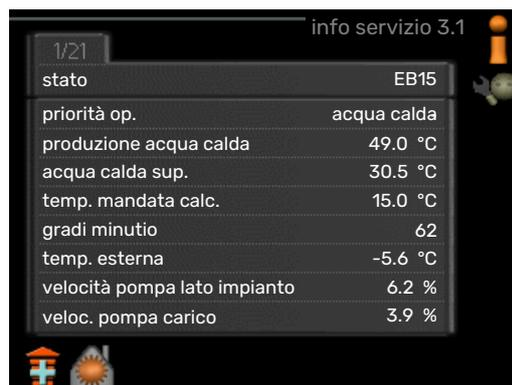
Qui è possibile ottenere informazioni sullo stato effettivo di funzionamento dell'impianto (ad esempio le temperature attuali e così via). Non è possibile effettuare modifiche.
