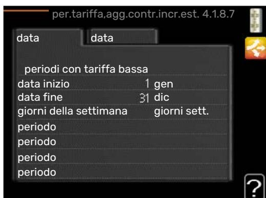
Qui è possibile utilizzare il controllo delle tariffe per il riscaldamento supplementare con controllo incrementale.
