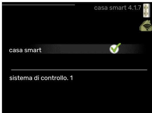
Quando si dispone di un sistema casa smart in grado di comunicare con NIBE Uplink, attivando la funzione casa smart in questo menu è possibile controllare VVM 500 mediante un'app.
