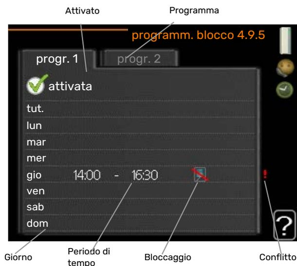
Qui è possibile programmare il blocco del compressore e/o l'unità supplementare presenti nel modulo interno per un massimo di due periodi di tempo diversi.
