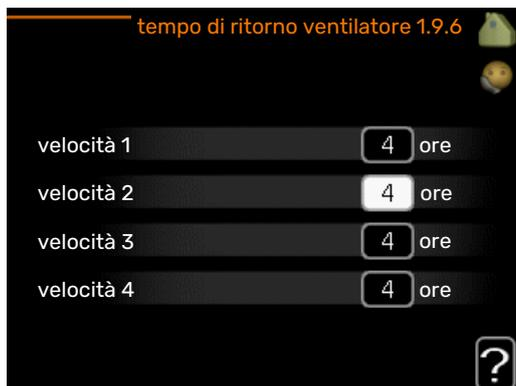
Qui viene selezionato il tempo di ritorno per la modifica temporanea della velocità (velocità 1-4) sulla ventilazione nel menu 1.2.
