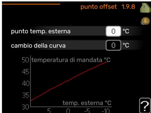
Selezionare qui un cambiamento nella curva di riscaldamento in presenza di una determinata temperatura esterna. Un incremento solitamente è sufficiente per cambiare la temperatura ambiente di un grado, ma in alcuni casi possono essere necessari più incrementi.
