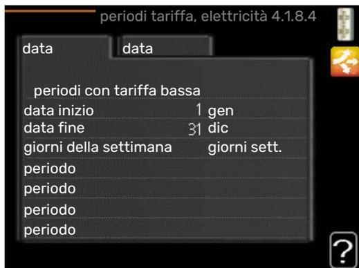
Qui è possibile utilizzare il controllo delle tariffe per il riscaldamento supplementare elettrico.
