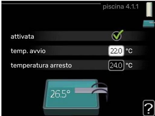
Selezionare se attivare il controllo piscina ed entro quali temperature (di avvio e di arresto) la piscina viene riscaldata.
