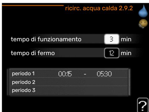
Impostare qui il ricircolo dell'acqua calda per un massimo di tre periodi al giorno. Durante i periodi impostati, la pompa di ricircolo dell'acqua calda resterà in funzione in base alle impostazioni di cui sopra.
