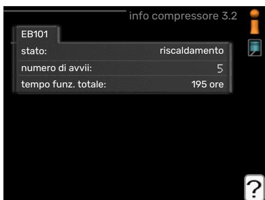
Qui è possibile ottenere informazioni sullo stato operativo del compressore e sulle statistiche. Non è possibile effettuare modifiche.
