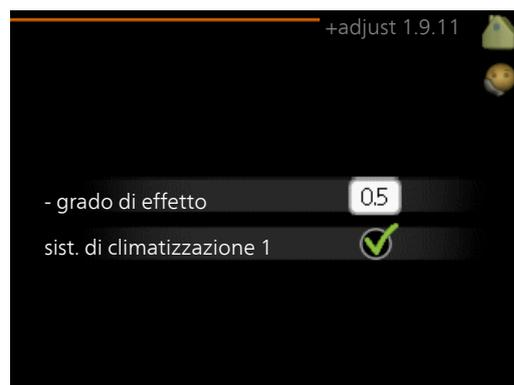
Utilizzando +Adjust, l'installazione comunica con il centro di controllo\* del riscaldamento a pavimento e regola la curva di riscaldamento e la temperatura di mandata calcolata in base all'impianto di riscaldamento a pavimento.
