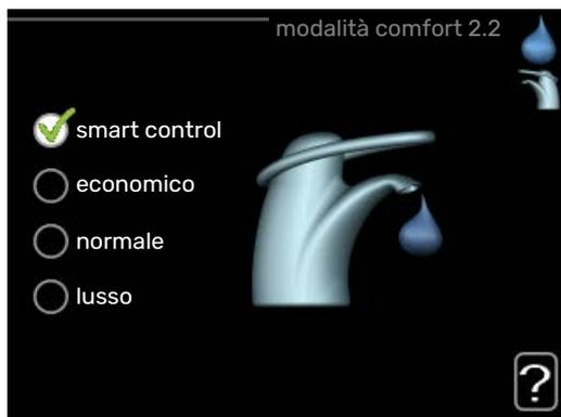
La differenza tra le modalità selezionabili è la temperatura dell'acqua calda del rubinetto. Una temperatura elevata indica che l'acqua calda dura di più.
