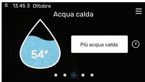
Qui è possibile avviare o arrestare l'aumento temporaneo della temperatura dell'acqua calda.
