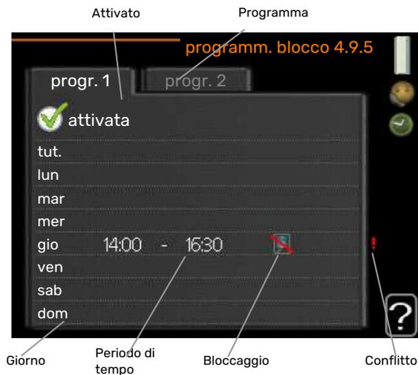
Qui è possibile programmare il blocco dei compressori presenti nella pompa di calore e/o del riscaldamento supplementare collegato ad essa per un massimo di due periodi di tempo diversi. Se sono presenti più pompe di calore collegate come master/slave, vengono bloccati anche i loro compressori.
