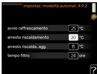
Quando la modalità operativa è impostata su "automatica", la pompa di calore seleziona quando è consentito avviare e arrestare il riscaldamento supplementare e produrre riscaldamento, in funzione della temperatura esterna media. Se sono presenti gli accessori per il raffrescamento, o se la pompa di calore dispone della funzione di raffrescamento integrata, è inoltre possibile selezionare la temperatura di avvio del raffrescamento.
