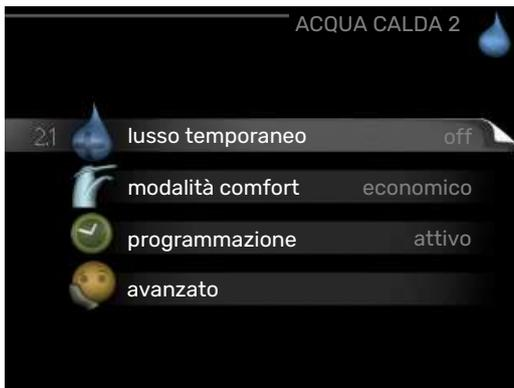
Questo menu appare solo se un bollitore viene collegato alla pompa di calore.
