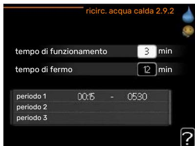
"tempo di funzionamento" decide per quanto a lungo la pompa di ricircolo dell'acqua calda debba restare in funzione per ogni istanza operativa.
