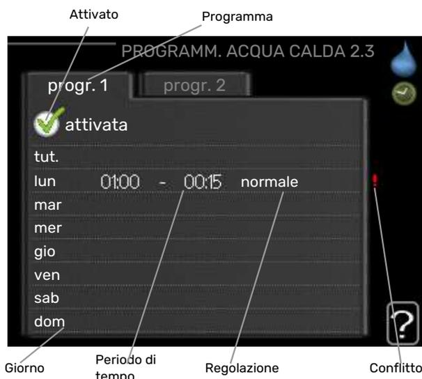
Qui è possibile programmare per un massimo di due diversi periodi al giorno il livello di comfort dell'acqua calda che la pompa di calore deve utilizzare.
